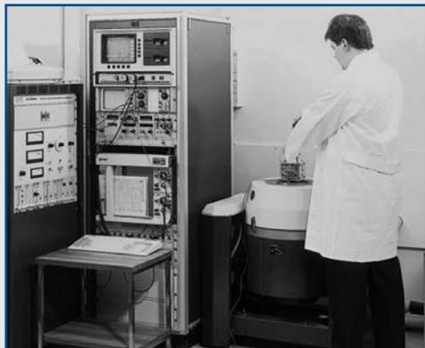
Banc de test en vibrations/Chocs
