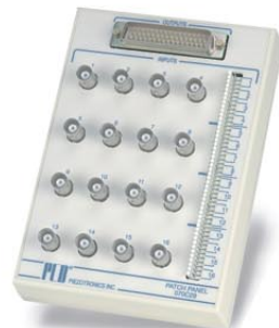
070C29 16-通道输入接线板 16个BNC jack 和16个IDC针输入 DB50 公头输出
