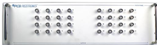
070A34 32-通道输入接线板 2个DB37公头输入 4个DB37母头伺服输入 4个DB50公头HP输出 32个BNC jack 输出 支架固定
